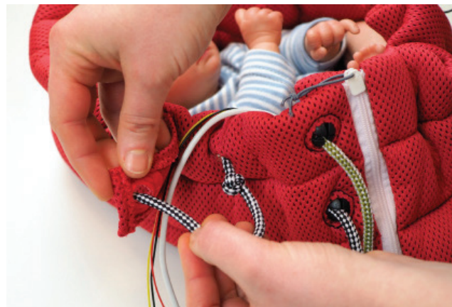
Abbildung 14: Kabel in der Schlauch- und Kabelführung
